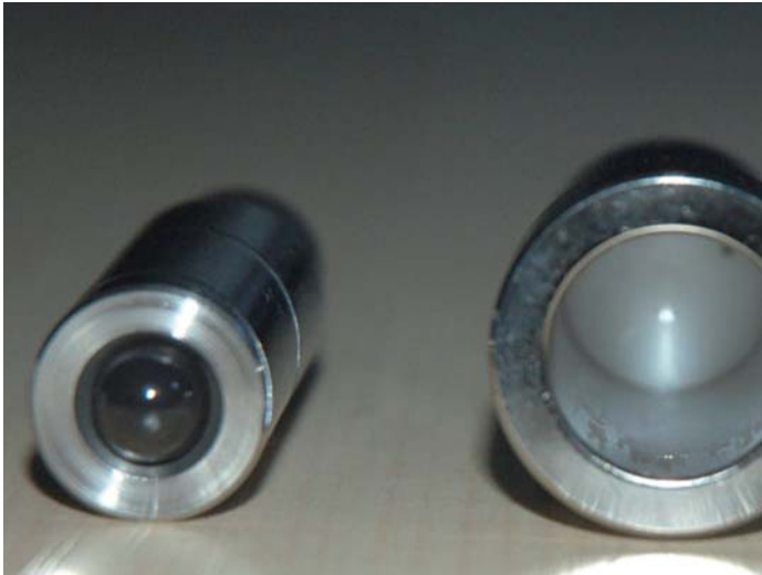
Bewährt: invertiertes Lager mit Keramikugel und Nylon-Scheibe
