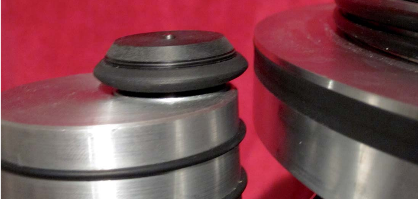
Sehr direkt: Pulley ohne Zwischenrad
